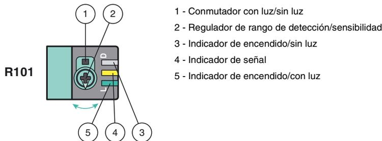
Para desbloquear las funciones de ajuste, gire el regulador de rango de detección más de 180 grados.
