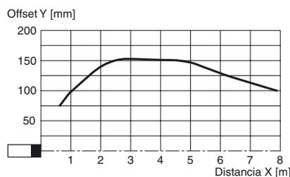
Desplazamiento posible de los ejes ópticos del emisor y receptor.
